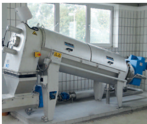
Statsionaarselt paigaldatud kruvipress 140 kg D /h jaoks
