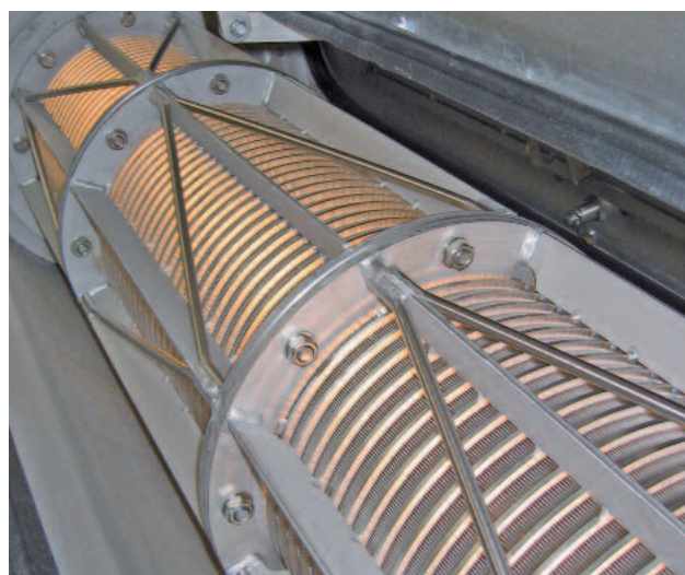
Vastupidav sõelakorv on valmistatud roostevabast terasest
